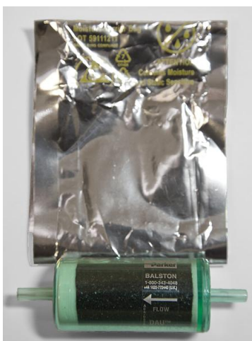
VITROS® Vapor Adsorption Cartridges zawierają czarny granulowany węgiel i znajdują się w srebrnym opakowaniu ochronnym.
