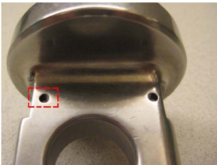
Rycina 1. Otwory na uchwycie raszpki przeznaczone do ustalania kąta antwersji
