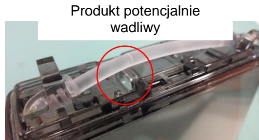
Mostek na płytce dociskowej z rurką pompującą przechodzącą nad mostkiem
