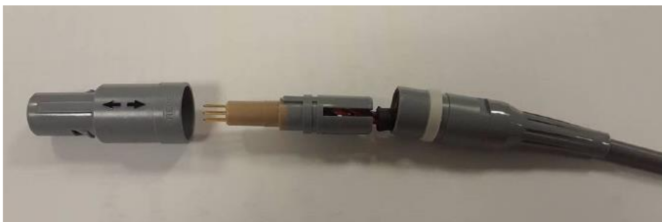
Ilustracja 1: Przykład złącza uszkodzonego mechanicznie
