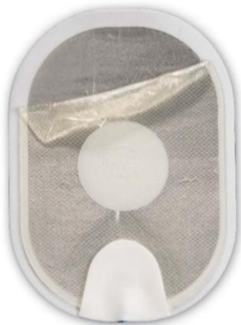
Ilustracja 1: Oddzielony żel, który zwinął się po odklejeniu.
