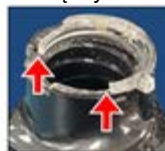
USZKODZONA obroż komory zbiornika
