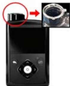
Zdjęcie: Lokalizacja obręczy w pompie insulinowej serii MiniMed™ 600
