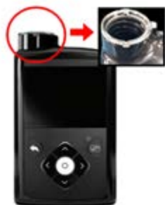
Zdjęcie: Lokalizacja obręczy komory na zbiornik w pompie insulinowej serii MiniMed™ 600
