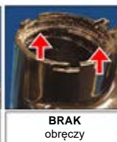
USZKODZONA obroż komory zbiornika
