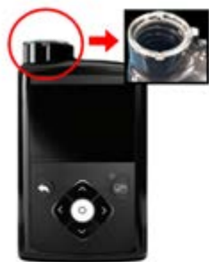
Zdjęcie: Lokalizacja obręczy komory na zbiornik w pompie insulinowej serii MiniMed™ 600
