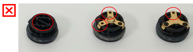
Uszkodzona zaślepka komory baterii – przerwać użytkowanie. Brak metalowego styku lub widoczne są mniej niż 3 wypukłe kropki.
