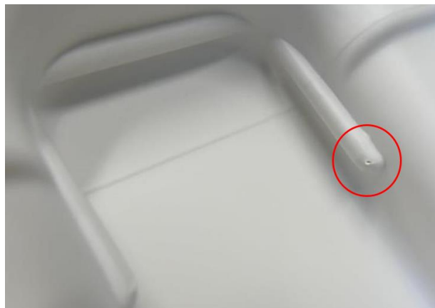
Przykład uszkodzonej tacy intellipack
