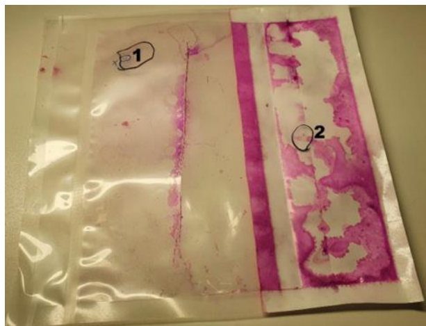
Przykład uszkodzonej tacy intellipack
