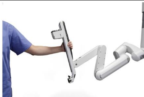
Rysunek 2: Ilustracja pokazująca jak prawidłowo trzymać USM podczas ręcznego pozycjonowania
