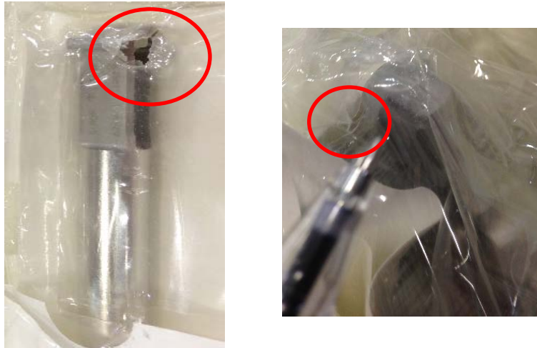
Rycina 2: Obrotowy zawiasowy element udowy S-ROM® Noiles z pęknięciami/otworami w torebce wewnętrznej i zewnętrznej
