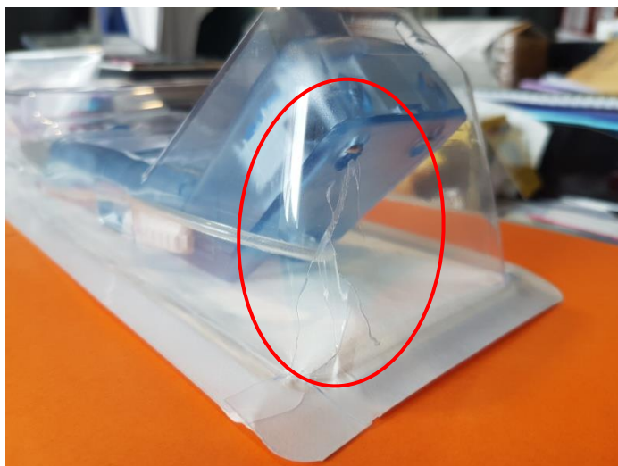
Rysunek 2: Przykład pęknięcia zaobserwowany w pobliżu manometru urządzenia nadmuchującego
