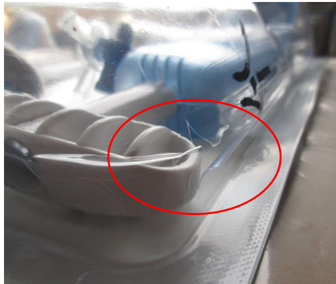
Rysunek 1: Przykład pęknięcia zaobserwowany w pobliżu uchwytu urządzenia nadmuchującego
